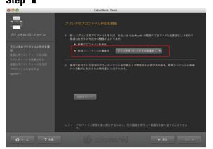
Colormunkiでは、作成したプリンタプロファイルを、特定の目的 にあわせて最適化することがきます。プリンタのプロファイル作成 を開始するときに、『既存プロファイルの最適化』を選択し、ポップアップメニューから最適化したいプリンタプロファイルを選択して下さい。 🚳 🗳
