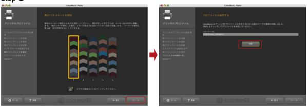
画面の指示に従って、チャートの1列目からスキャンをします。正しく測定できると画面に表示されているオレンジ色の囲みが次の列に移動します。読み込みに失敗した場合は囲みが赤くなりますので、もう一度スキャンし直して下さい。すべての列をスキャンしたら、『次へ』をクリックし、作成したプロファイルの名前を確認して『保存』をクリックします。 ௴ ௴
