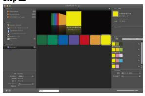
Colormunkiで測色した色は、自動的にユーザへパレット登録されます。事前にユーザパレットを作成していない場合は、ユーザパレットを作成して、別途表示されているパレットからドラッグ&ドロップをして下さい。 🚳 🍪
