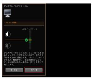
測定器をディスプレイに設置したまま、ディスプレイ本体に搭載されているOSD機能を使ってコントラストを調節していきます。品質インジケータのグリーンの範囲までメーターが移動したら『次へ』をクリックして下さい。 ⑥ ⑥
