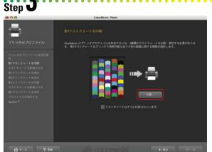
プロファイルを作成する設定ができたら『印刷』をクリックして、 第1テストチャートを印刷します。正しくチャートを出力するため には、プリンタドライバの色補正機能をオフにしておく必要があり ます。 🚳 🚳
