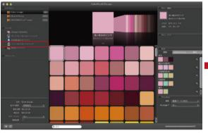
Colormunki DesignではColor Palette画面左側の「リソース」から『プリンタのプロファイリング』を選択し、『プリンタのプロファイル…』をクリックしてキャリブレーションを開始します。 🍪
