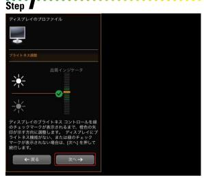
次に、ディスプレイのブライトネスを調整します。ディスプレイ本体に搭載されているOSD機能を使ってブライトネスを調節していきます。品質インジケータのグリーンの範囲までメーターが移動したら『次へ』をクリックして下さい。 🚳 🐠
