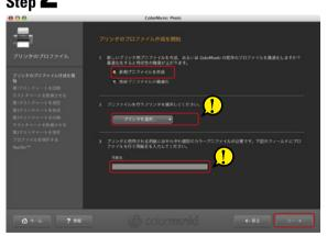
まず『新規プロファイルを作成』をクリックし、ポップアップメニューからパソコンに接続されているプリンタを選択します。続いて用紙名を入力したら『次へ』をクリックします。 🚳 🍪
