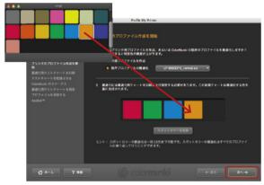
Colormunki Designでは、ライブラリの中から、最大5色までを選択して最適化を施すことができます。ライブラリまたはユーザパレットからスポットカラーをドラッグすると、プリンタプロファイルを最適化するためのチャートが生成されます。 ⑥
