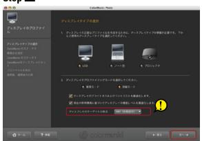
プロファイリングを行うディスプレイの種類を選択します。液晶ディスプレイの場合は『LCD』を、ノート型の場合は『ノート型』を選択します。次に『簡易モード』か『詳細モード』を選択してウィンドウ右下の「次へ」をクリックします。 ⑥ ⑥
