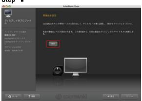
ディスプレイの近くに測定器を置いて、『測定』をクリックします。 この測定結果からColormunkiが最適なブライトネスの目標値を設 定します。 🔮 🍪
